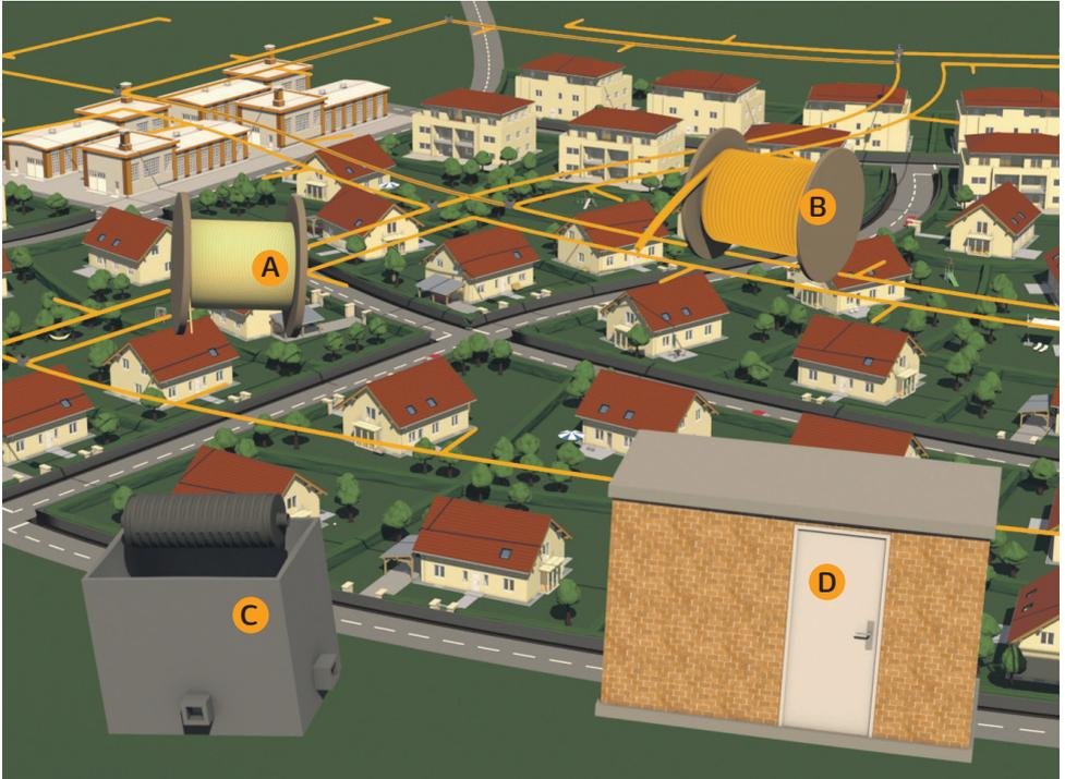
Das Glasfasernetz einer Gemeinde besteht aus vielen verschiedenen Komponenten: Glasfaserkabel **A**, Leerrohre **B**, Anschlusschächte **C**, Verteilerkästen **D**, aber wie kommt die Glasfaser genau ins Haus?
