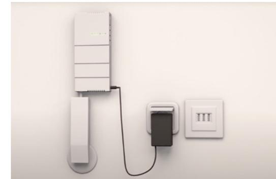
Aufbau aus Kabelgehäuse und Netzabschlussgerät.
