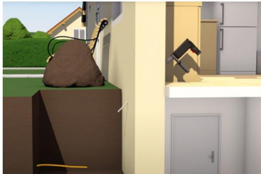
Variante 2: durch eine Diagonalbohrung kommt das Leerrohr im Erdgeschoss an.
